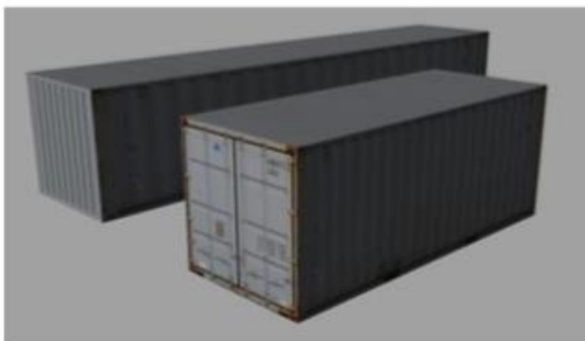
Figura 15: Comparação entre FEU e TEU, sendo o primeiro o dobro do comprimento
